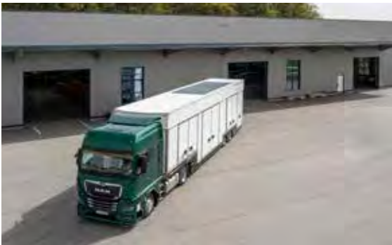
Etwa 20 Quadratmeter Solarkollektoren sorgen für grünen Strom an Bord.
